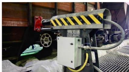
Вагонный виброразгрузатель пневматический VH
